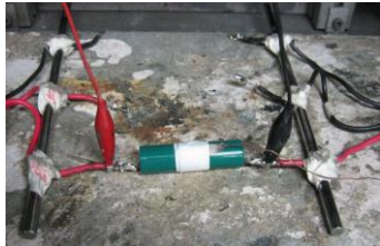
試験② 外部短絡試験 （ニッケル水素蓄電池）
