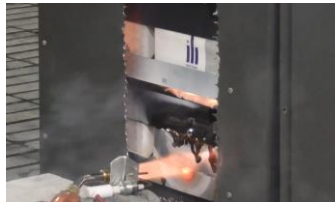
試験③ 類焼試験 （リチウムイオン蓄電池）
