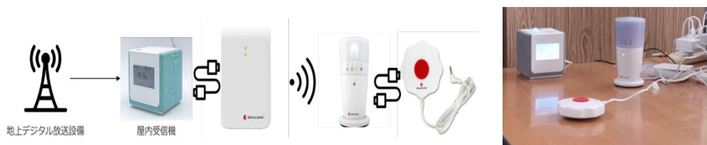
図 4 屋内受信機とマルチセンサ発信器等との接続イメージ
